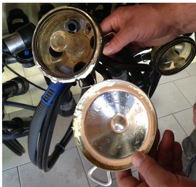
Abb. 3: Ablagerungen in einem Sammelstück
